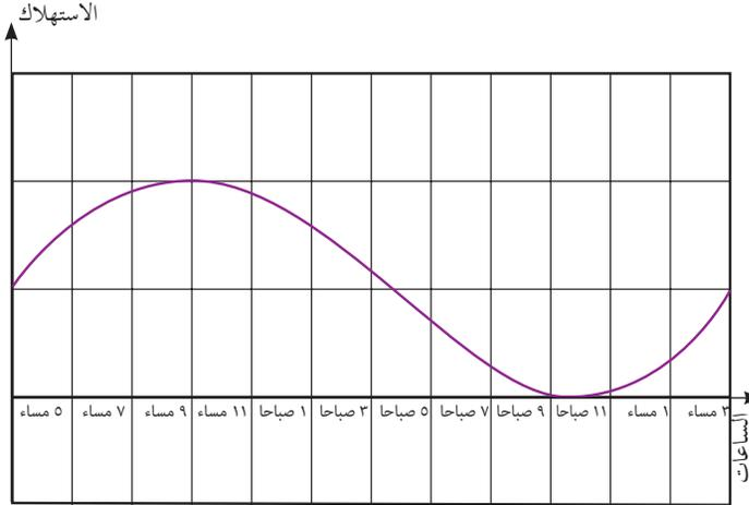
تعدّ الكهرباء مطلباً أساسياً في حياة المواطنين. فدونها تعطل الكثير من الفعاليات. ويتم رصد استهلاك الكهرباء في فلسطين على مدار الساعة. الشكل المجاور يوضح توزيع الأحمال اليومية من الكهرباء في منطقة القدس وضواحيها في اليوم الأول من عام ٢٠١٨ م.
